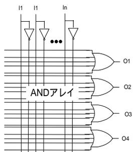
PAL: 積和型の組合せ論理回路でORアレイを固定化したもの(単純・高速)
