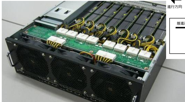
GPUをExpEtherで接続したGPUBOX
